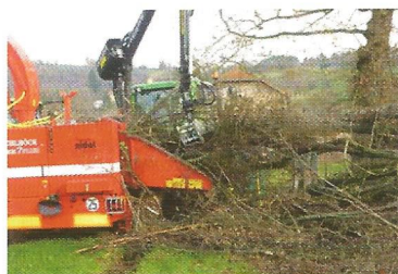
Préparation du bois avant déchiquetage : élagage des arbres, recépage modéré des arbustes. Diamètre des branches broyées : 5 à 25 cm. Gros bois à préparer à part.
